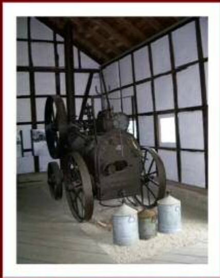
Vor der Erfindung des Verbrennungsmotors wurde auch in der Landwirtschaft die Dampfkraft eingesetzt. Die Lokomobile diente als Antrieb für Dreschmaschinen.
